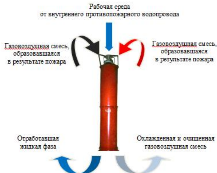
Рисунок 1 – Схема работы ПРТА
