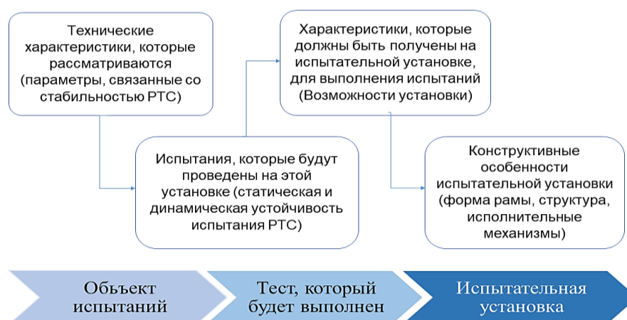
Рисунок 2 – Основные направления по созданию новой испытательной установки (испытательного стенда для РТС)
