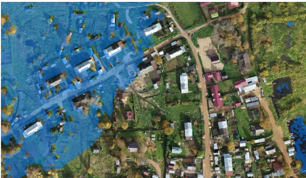
Рисунок 3 – Прогноз подтопления н.п. Усть Усть-Кубинского МР при повышении уровня воды на 0,5 м.
