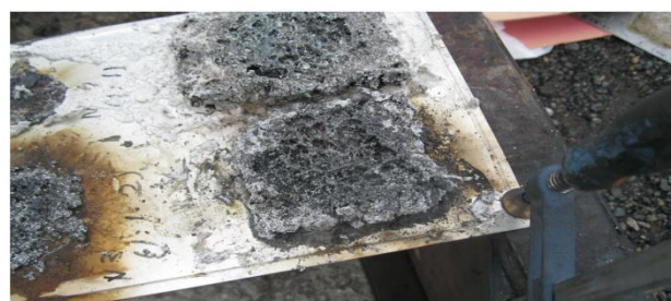
Рисунок 1, 2 – Огневые испытания образцов с огнезащитной пастой на основе перлита
