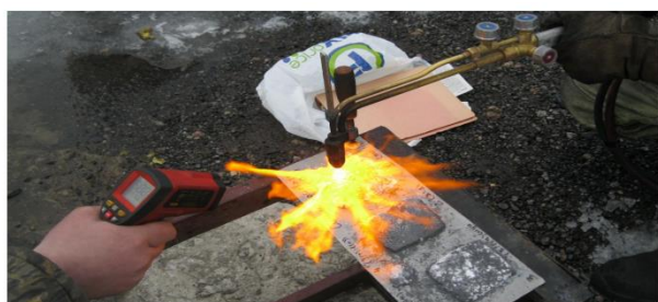
Рисунок 1, 2 – Огневые испытания образцов с огнезащитной пастой на основе перлита
